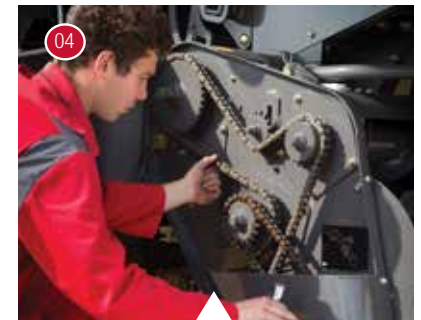
04 Überprüfen der Pickup-Kettenspannungen.
