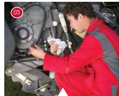
03 Überprüfen des Ölstands des Schneidwerkgetriebes.
