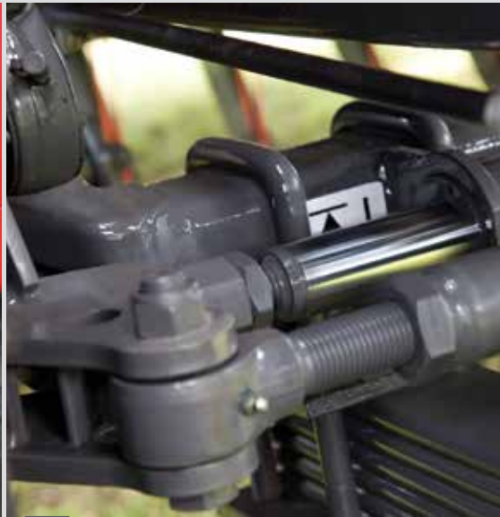
Hydraulische Lenksperre der Hinterachse.
