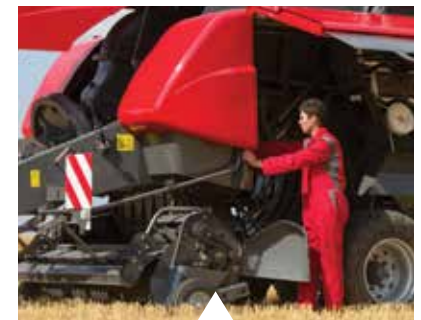
Auffüllen des automatischen Kettenölers.
