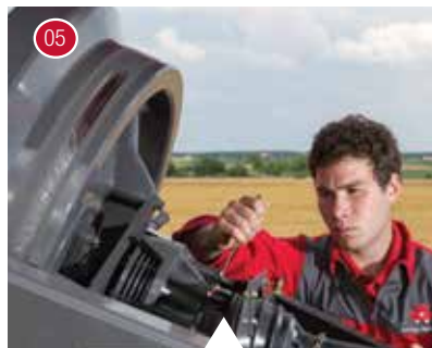
05 Einstellen der Schwungrad-Rutschkupplung.
