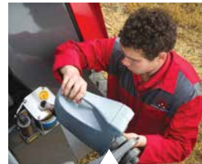
Auffüllen des automatischen Kettenölers.
