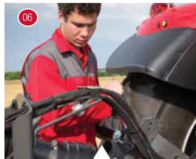
06 Schmieren der Zapfwelle.
